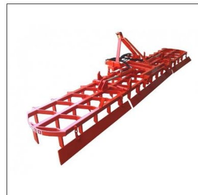
Figura 3. Grada de púas, también llamada “rastra” o “peine” según zonas (Fuente: Noli).
