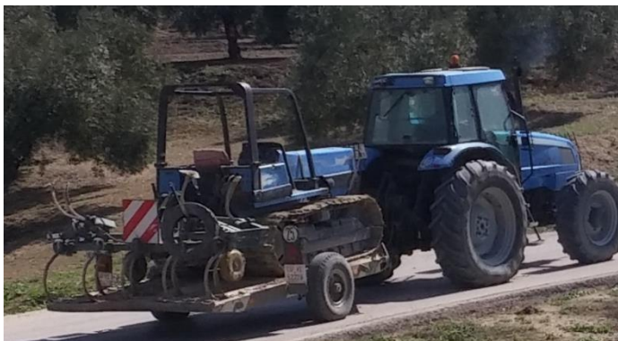
Figura 2. Cultivador de 13 brazos sobre tractor oruga transportado en una batea. En el olivar tradicional se dan dos (y hasta tres) pases por calle y se cruzan.
